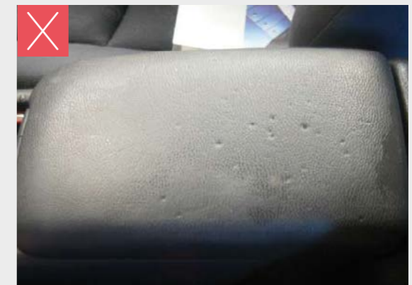
AUSGEPRÄGTE ABNUTZUNGEN SOWIE RISSE, SCHNITTE UND LÖCHER IN AUSSTATTUNGSELEMENTEN DES INNENRAUMS
