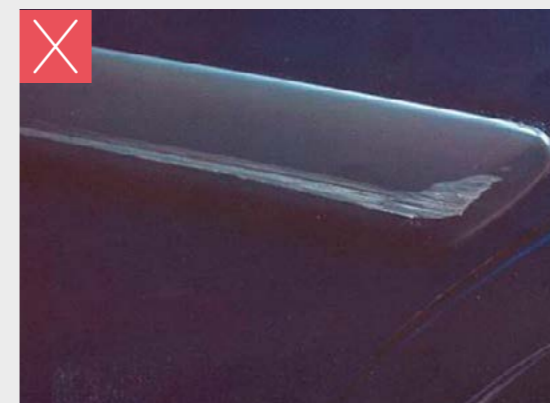
ABRIEB BIS AUF DEN GRUNDWERKSTOFF UND ÜBER EINE LÄNGE VON MEHR ALS 100 MM
