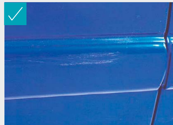
LEICHTER ABRIEB, DER KEINE NEULACKIERUNG ERFORDERLICH MACHT, ÜBER EINE LÄNGE VON WENIGER ALS 100 MM
