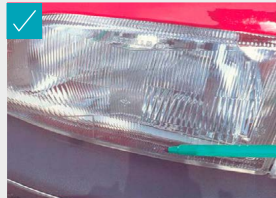
STREUSCHEIBE MIT GERINGFÜGIGER ABSPLITTERUNG IST AKZEPTABEL, FALLS ES SICH NICHT NEGATIV AUF DAS ERSCHEINUNGSBILD DES FAHRZEUGS ODER DEN WIRKUNGSGRAD DER LEUCHTE AUSWIRKT
